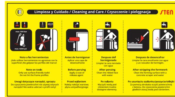
Etiqueta con las instrucciones de limpieza y mantenimiento presente en todos los paneles.
